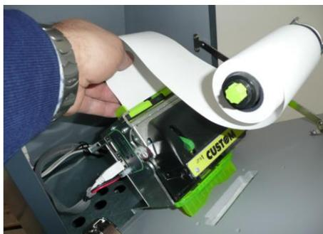
L'operazione di caricamento della carta è semplificata nei sistemi FilaVia® Olè dalle caratteristiche di auto caricamento delle stampanti adottate. Le stampanti TG2480 adottano un tipo di carta da 79mm per 150metri di lunghezza massima del rotolo e sono montate in modo analogo nel dispenser sull'apposito sostegno basculante. Il sostegno basculante consente di localizzare facilmente la bocca di inserimento della carta posta nel retro della stampante in modo tale da facilitare le operazioni
