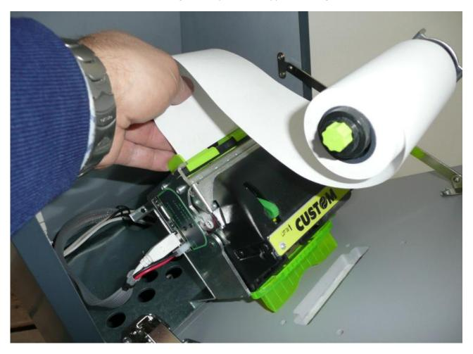
Il sostegno basculante consente di localizzare facilmente la bocca di inserimento della carta posta nel retro della stampante in modo tale da facilitare le operazioni frontali di caricamento carta.
