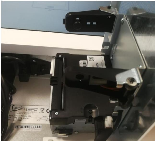
La carta viene caricata automaticamente una volta alimentata la stampante inserendo un lembo del rotolo tagliato in modo regolare ed ortogonale.
