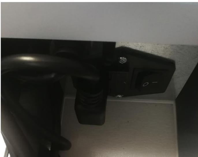
E' possibile accedere alla scatola dal foro posteriore e poi utilizzare il cavo in dotazione oppure la presa VDE fornita, cablandola all'impianto elettrico.
